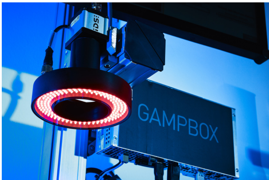
Bild 2 | Die GampBox besteht aus einem Box-PC und einer GMP-konformen Benutzeroberfläche.
